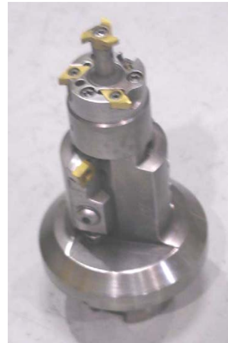
连杆半精镗大头孔 复合刀具
